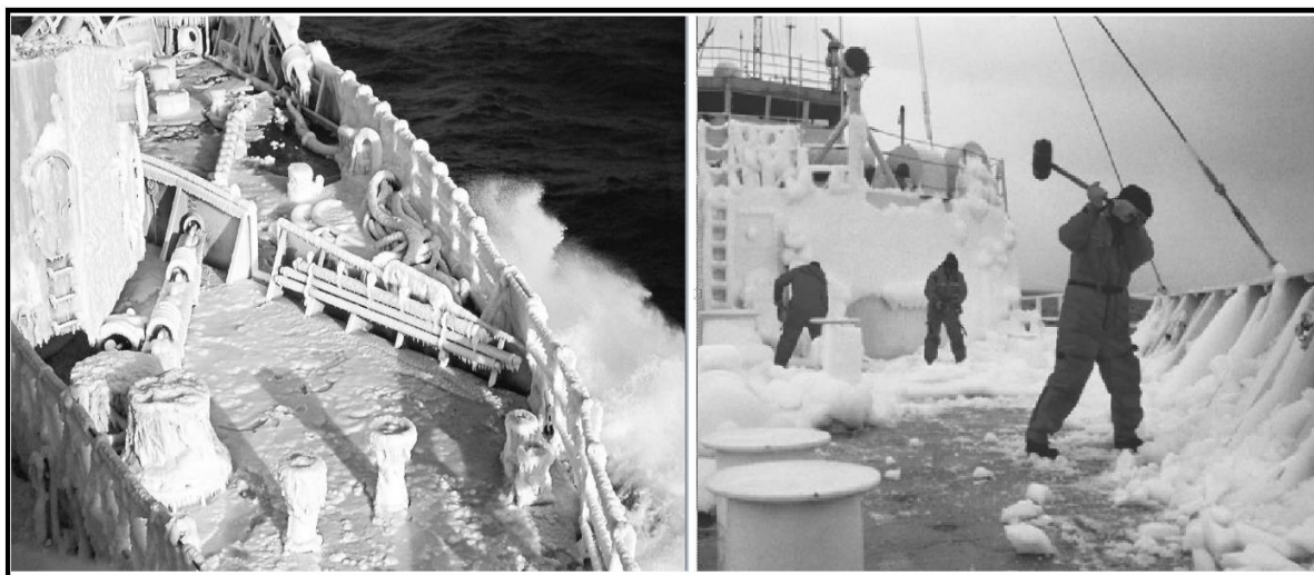
Рис. 2.3. К задаче № 2.1.6. Проблемы с обледенением на арктических судах и удаление льда
