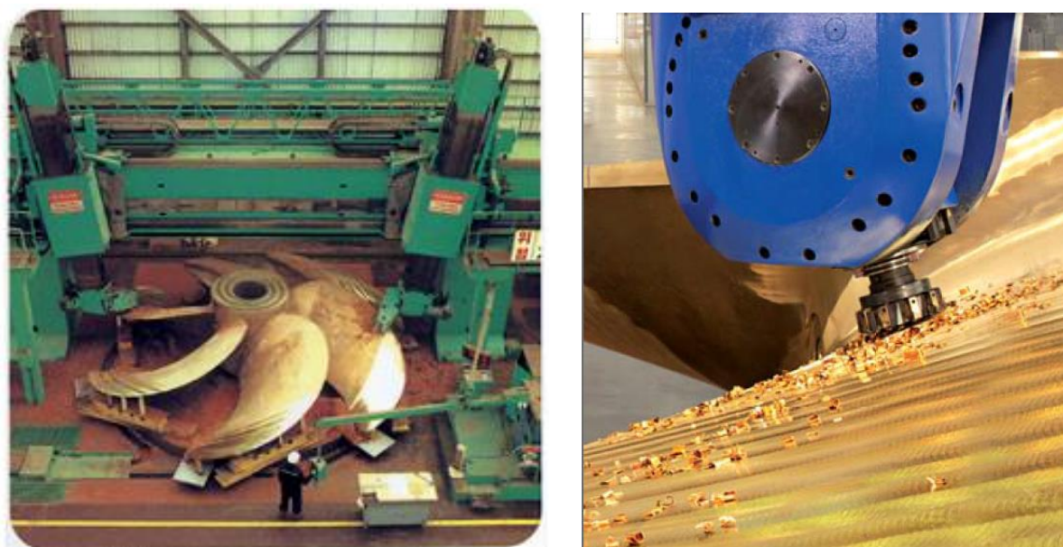
Рис. 2.4. К задаче № 2.2.1. Станок для обработки гребных винтов, фрезерная головка и фреза при обработке
