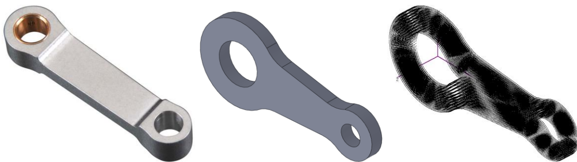
Рис. 2.10. К задаче № 2.2.4. Шатун, его модель и волокна в его теле
